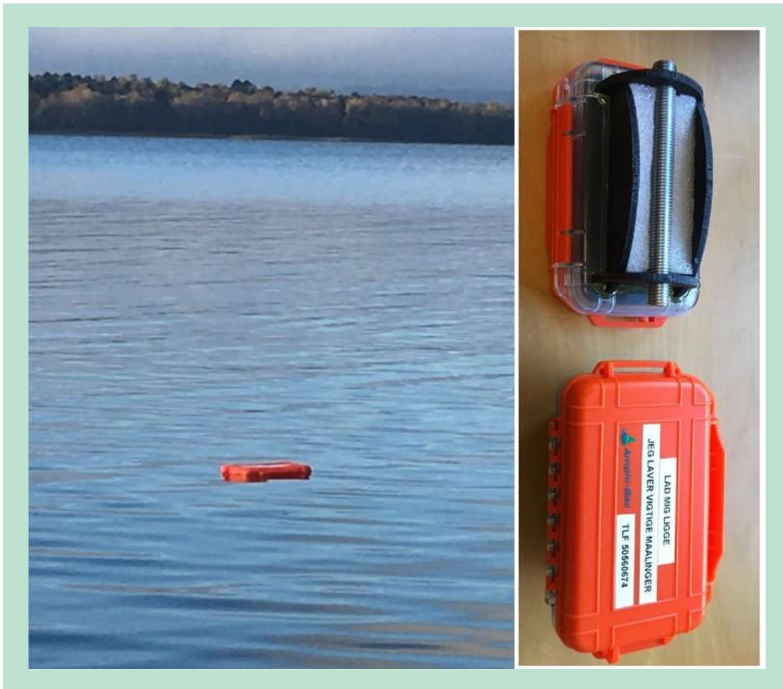
FIGUR 12. Til venstre en GPS-tracker, der flyder med strømmen i Skanderborg Sø. Til højre se for- og bagside af GPS-trackeren.
