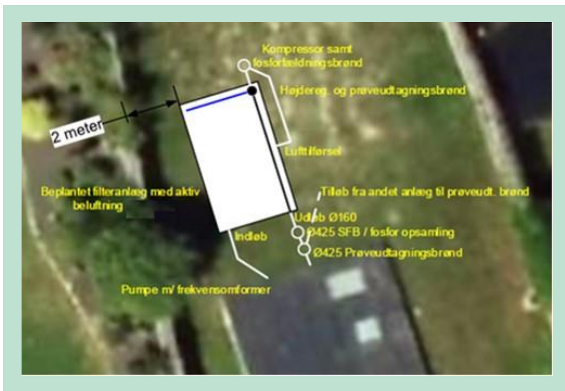
FIGUR 21. Skitsetegning over det beplantede filter på det udvalgte testsite. Kilian Water.
