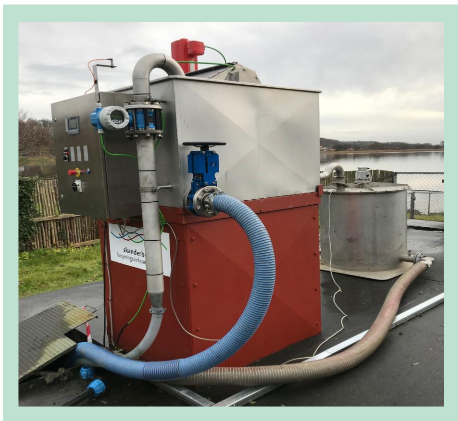
FIGUR 24. Den endelige kompakte renseløsning, bestående af 0,4mm Stjernholm RO rist efterfulgt af PAA desinfektionstank.
